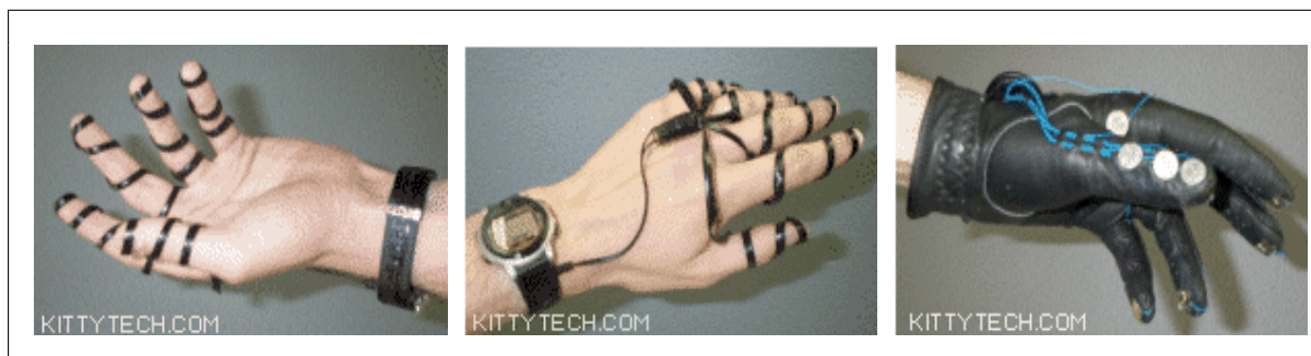
Abbildung 5: links & mitte: der aktuelle Kitty Prototyp, rechts: handschuhbasierte Entwurf
