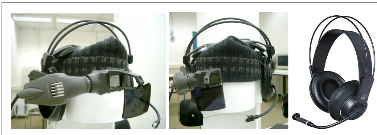
Abbildung 8: links: Xybernaut HMD mit Headset in Seitenansicht, mitte: Frontansicht, rechts: Stereo-Headset der Firma AKG - Basis für die Konstruktion?
