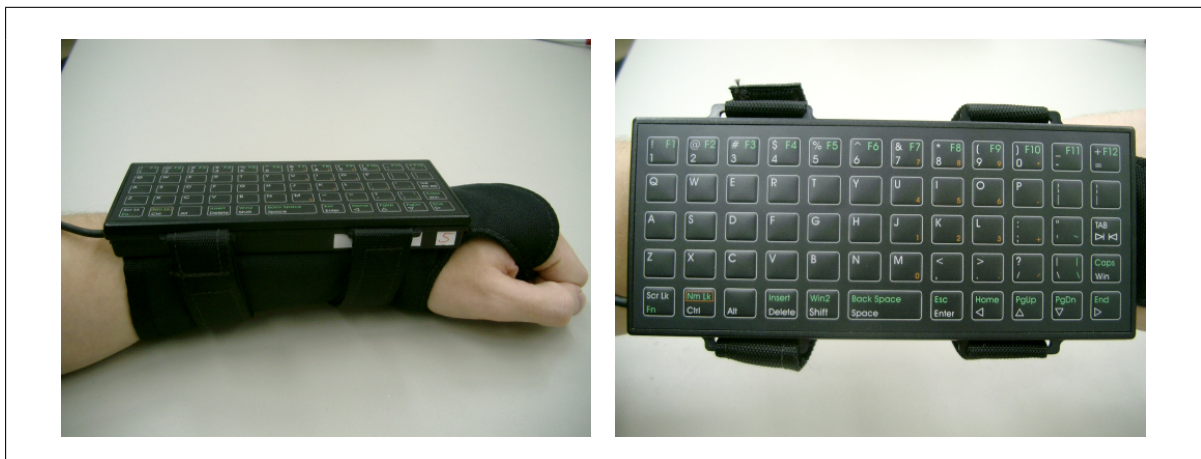
Abbildung 3: links: Xyberkey™ -Tastatur mit Befestigung, rechts: Tastaturlayout
