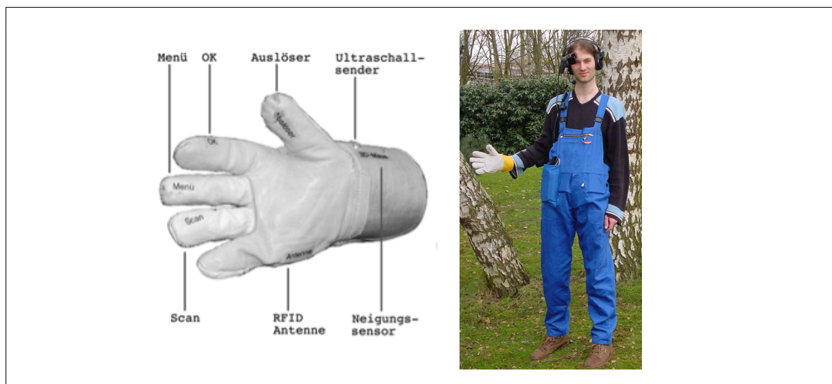
Abbildung 7: links: Winspect-Handschuh, rechts: Winspect-Gesamtsystem
