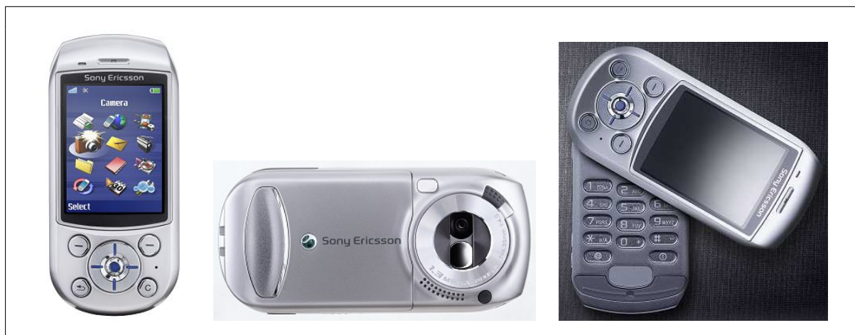
Abbildung 12: links: S700 im Organizer-/Handybetrieb, mitte: Rückansicht mit Kamera, rechts: verborgene Tastatur
